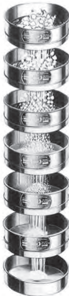
Ryc. nr 1 - Zestaw sit do analizy granulometrycznej uziarnienia warstwy wodonośnej i obsypki żwirowej [5]
