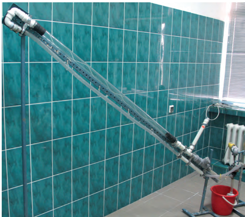
Rys. 1. Modelowe stanowisko badawcze – pętla pomiarowa do transportu zwiercin w otworze o różnym kącie odchylenia
