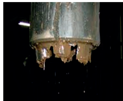
Rysunek 7. Skuteczny zabieg ucięcia obciążnika przy użyciu Severing Tool'a. Źródło: JetResearch.com
