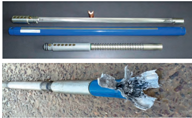
Rysunek 11. Rozcinacz typu Split Shot Cutter przed i po użyciu w otworze. Źródło: Geofizyka Toruń
