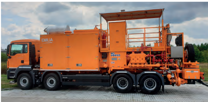
Agregat cementacyjny CPT-700. Fot. arch. Exalo Drilling S.A.
