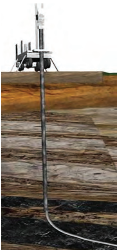
Rys. 1. Widok otworu horyzontalnego wierconego w formacjach łupkowych [12]
