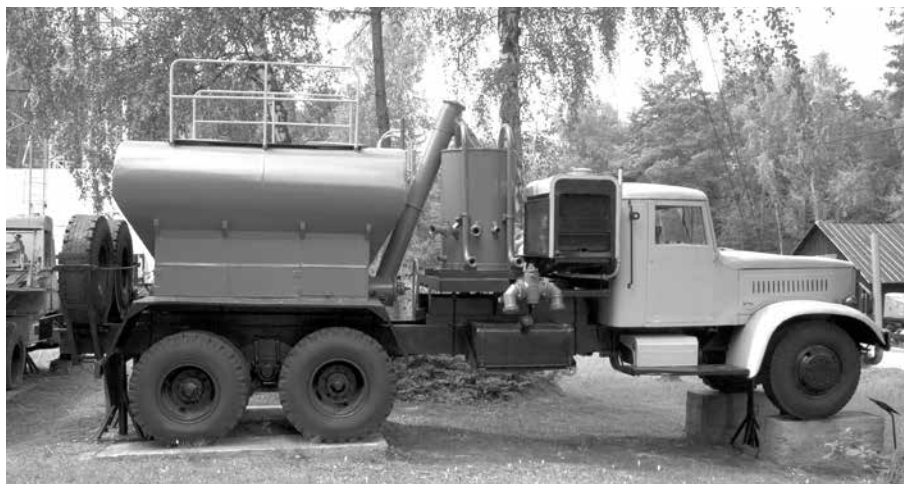
Mieszalnik piasku na podwoziu Kraz. (fot. archiwum Fundacja Bóbrka)
