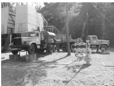
Rozmieszczenie urządzeń : 1,2- agregaty wysoko ciśnieniowe, 3- mieszalnik piasku, 4- agregaty pomocnicze, 5- zbiorniki cieczy zabiegowych (fot. i rys. ze zbiorów autora)
