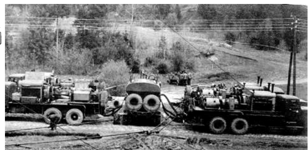
Rozmieszczenie urządzeń : 1,2- agregaty wysoko ciśnieniowe, 3- mieszalnik piasku, 4- agregaty pomocnicze, 5- zbiorniki cieczy zabiegowych (fot. i rys. ze zbiorów autora)
