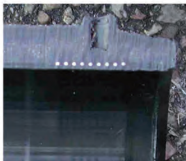
Fot. 1. Przekrój mufy z drutem wyprowadzonym na powierzchnię i przykrytym warstwą PE
