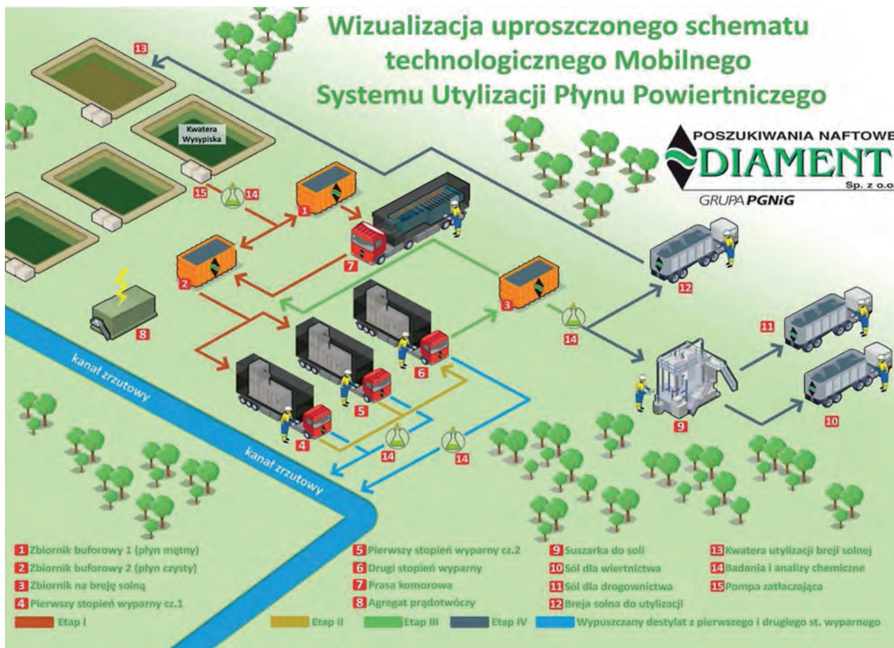
Rysunek nr 2. Wizualizacja schematu technologicznego Mobilnego Systemu Wyparnego
