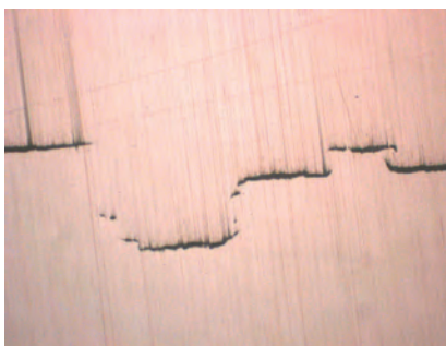
Fig. 6. Fragment pęknięcia na próbce wytopu 563676
