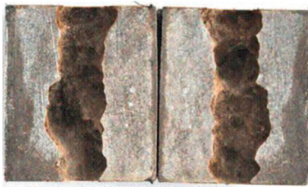
Fot. 9. Wytrawiona powierzchnia szczeliny podczas dziewięcioetapowego kwasowania w porządku: 15% HCl/ liniowy żel/ HCl; kwas mśrówkowy w stosunku 10:7/ żelowany HCl/ liniowy żel/ 15% HCl/ HCl; kwas mśrówkowy w stosunku 10:7/ żelowany HCl/ 15% HCl
