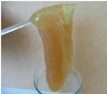
Fot. 5. Żelowany i usieciowany kwas HCl
