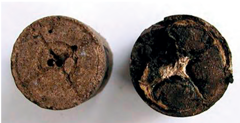
Fot. 6. Rdzenie poddane działaniu żelowanych i usieciowanych kwasów
