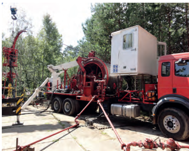
Coiled tubing. Fot. arch. PGNiG SA – Oddział w Sanoku
