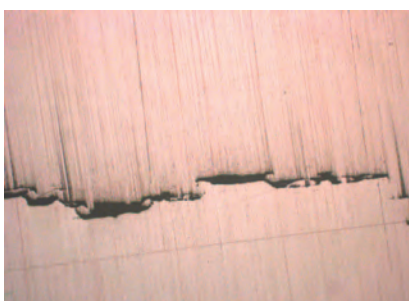
Fig. 7. Fragment pęknięcia na próbce wytopu 563676 – pow. 100-krotne
