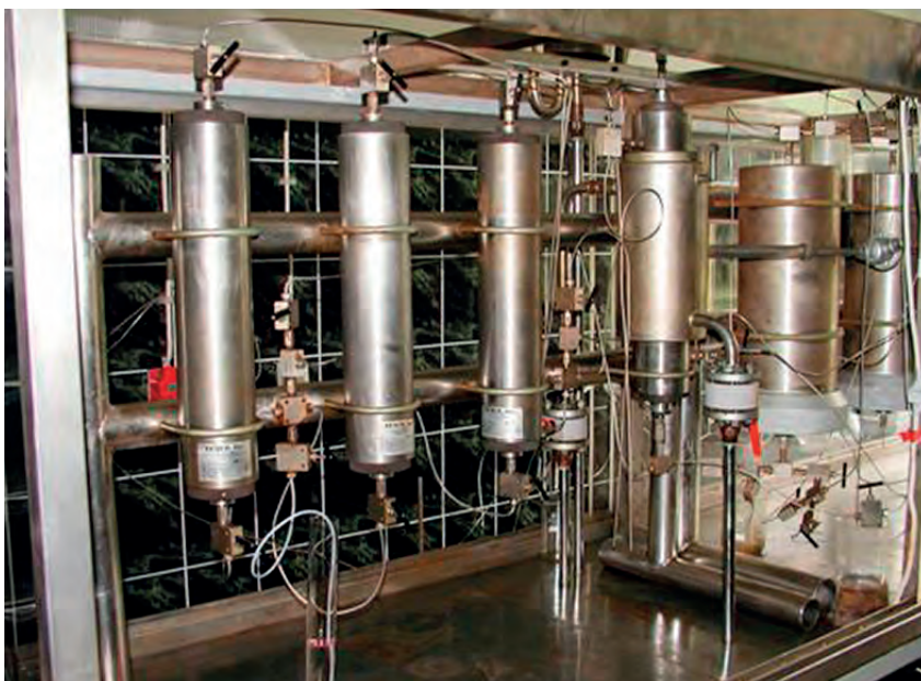
Fot. 3. Zestaw zbiorników na ciecz robocze i uchwyt na rdzeń (Acid Delivery System)
