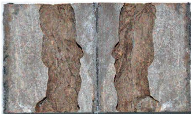
Fot. 8. Wytrawiona powierzchnia szczeliny podczas dwuetapowego kwasowania w porządku: żelowany 15% HCl/ 15% HCl
