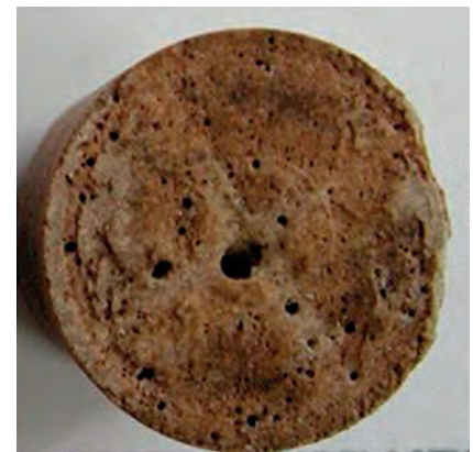
Fot. 7. Powierzchnia czołowa rdzenia po kwasowaniu cieczą viskoelastyczną
