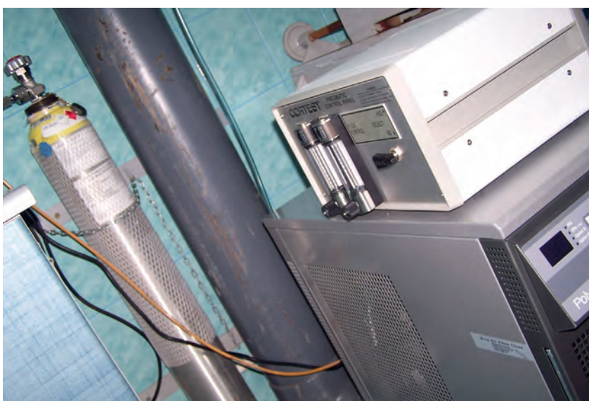
Fig. 2. Zestaw sprzętowy utrzymujący warunki podczas testu HIC w komorze badawczej
