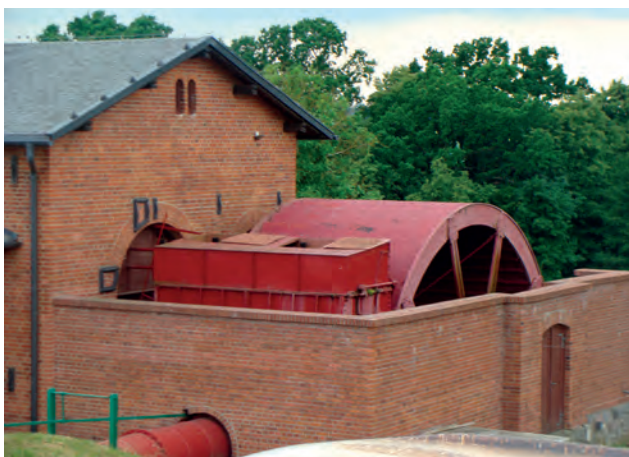
Fot. 3. Koło wodne napędzające mechanizm. Fot. A. Olszacki
