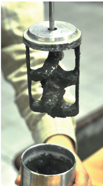
Fot. 2. Wyciąganie mieszadła z celi po zakończeniu pomiaru (zaczyn częściowo związany)
