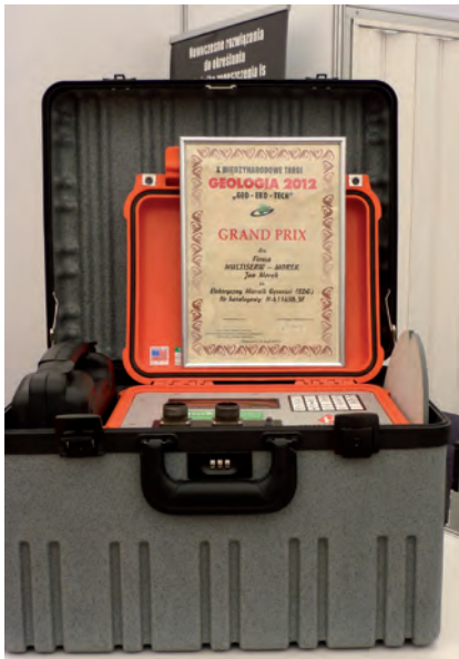
Fot. 4. Miernik gęstości EDG. Fot. J. Zagórski
