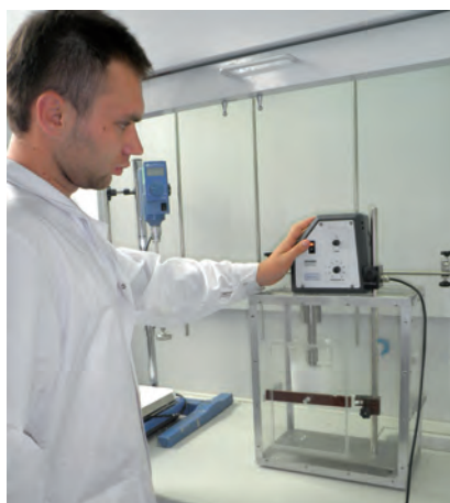
Laboratoryjny homogenizator ultradźwiękowy UP400S o mocy 400 W, produkcji firmy Hielscher Ultrasonics GmbH, 24 kHz. Fot. arch. INiG
