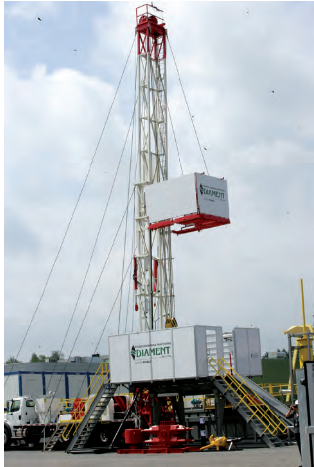
Najnowsze urządzenie wiertniczo-rekonstrukcyjne Diamentu SK – 175. Fot. arch. PN Diament Sp. z o.o.
