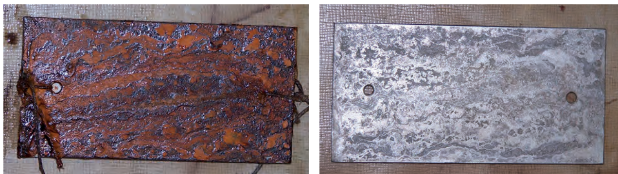
Fig. 1. Przykładowa próbka poddana testowi kontrolnemu powtarzalności wyników przed (po lewej) i po oczyszczeniu z produktów korozji (po prawej)
