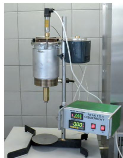
Reaktor ciśnieniowy z układem grzewczym i chłodzącym oraz regulacją temperatury i intensywności mieszania. Fot. arch. INiG
