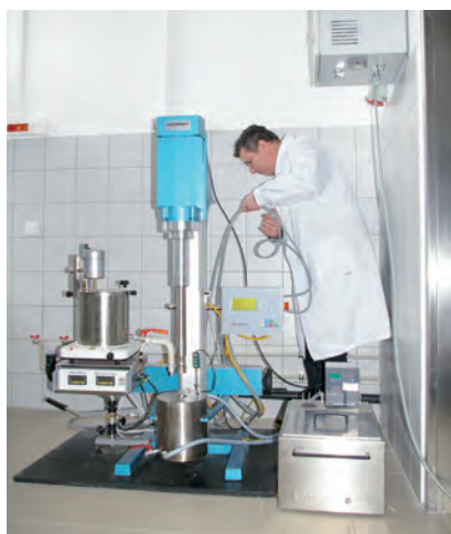
Mieszalnik DISPERMAT CA 60M f-my VMA GETZMANN GmbH z końcówką homogenizującą, o szybkości obrotów mieszadła do 20.000 obrotów na minutę. Fot. arch. INiG
