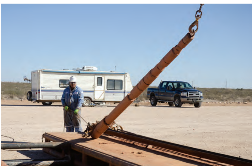
Łączniki redukcyjne pozwalają połączyć świder z elementami przewodu wiertniczego w zakresie od 4½” do 6½”. Amortyzator drgań tego odcinka pochłania połowę uderzeń przenoszonych ze świdra na głowicę obrotową. Fot. arch. Atlas Copco Polska Sp. z o.o.
