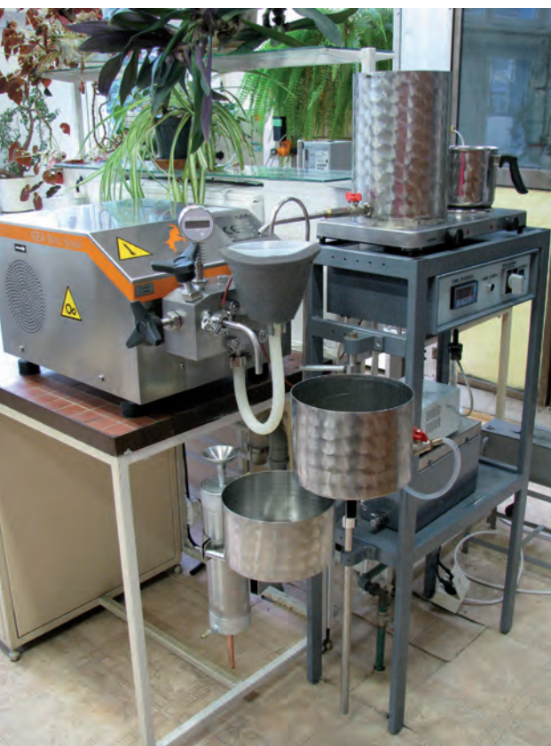
Laboratoryjny homogenizator wysokociśnieniowy NS 1001L PANDA 1K, produkcji firmy Gea Niro S.p.A. Fot. arch. INiG
