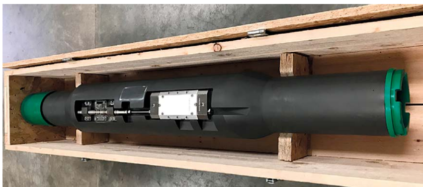
Rys. 6. Trzpień montażowy (mandrel) z obudową rozdzielacza światłowodowego. (Źródło: [10]).
