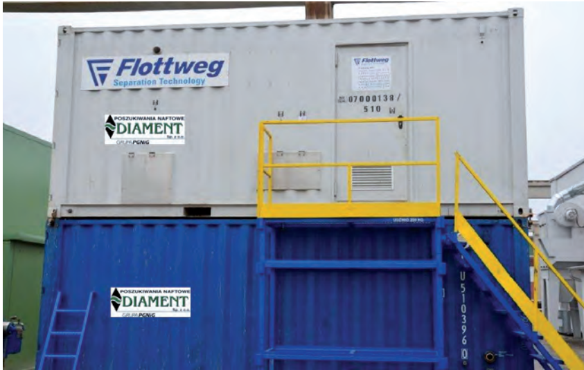
System oczyszczania płuczki złożony z wirówki Flottweg zamontowanej na stacji flokulacyjnej - sprawdzili się podczas wiercenia otworu Opalino-2. Fot. arch. PN „Diament” Sp. z o.o.
