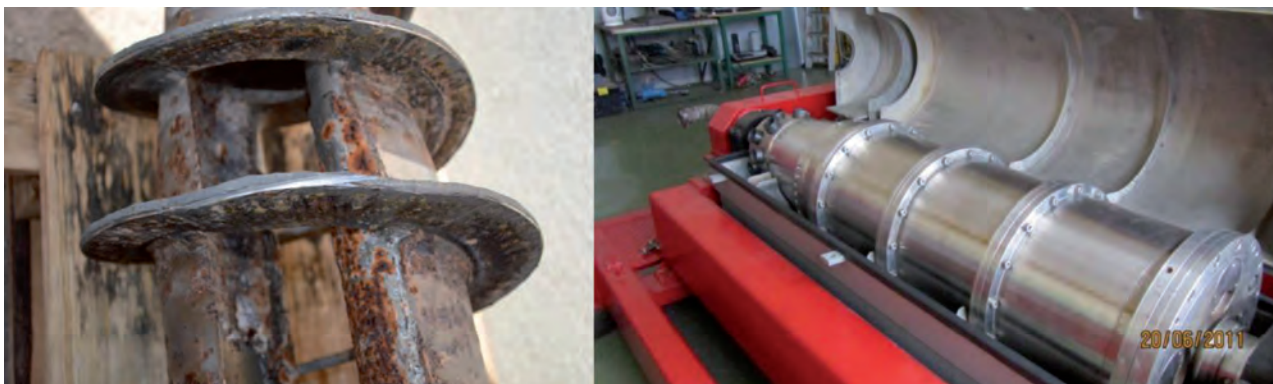
Jakość wykonywanych remontów – wirówka Swaco przed i po remoncie w Warsztacie Technicznym PN „Diament” w Zielonej Górze. Fot. arch. PN „Diament” Sp. z o.o.
