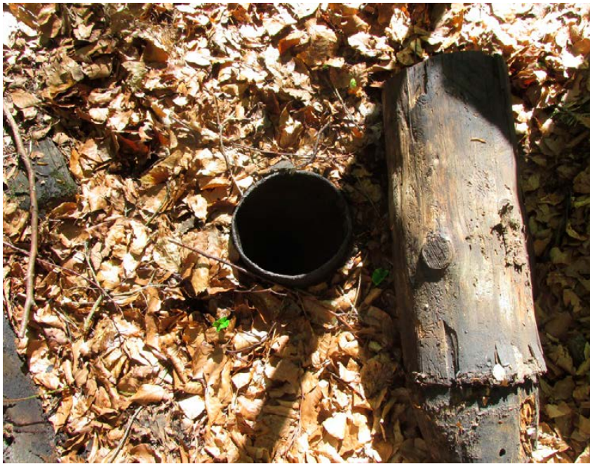
Rysunek 2. Miejsce poboru próbki wycieku ropy naftowej z terenu dawnej kopalni Polana-Ostre. Próba pobrana z szybu V, z głębokości około 3 metrów.
