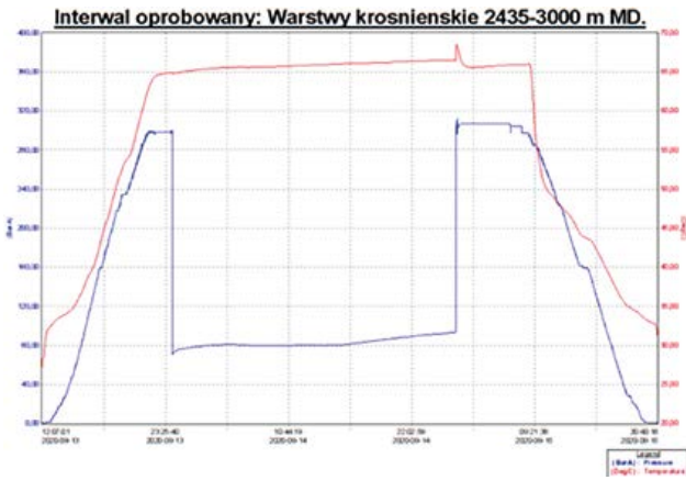
Rys. 9. Oprobowanie rurowym próbnikiem złoża interwału 2435-3000 m MD
