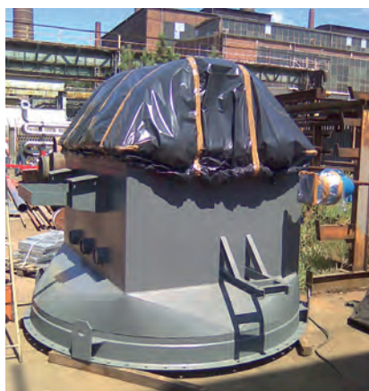
Rysunek 6. Wymiennik konwekcyjny z obudową przygotowany do transportu
