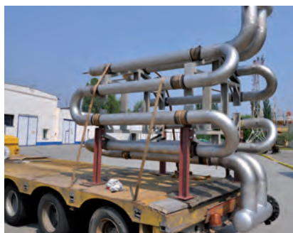
Rysunek 7. Wymiennik radiacyjny na naczepie niskoplatformowej
